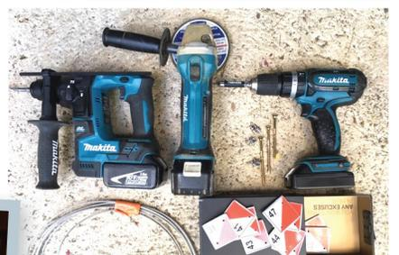
Et vous munir du matériel suivant pour les poser: Câble inox Ø3mm, coupe câble et serre-câbles pour pose sur arbres. Chevilles Ø8mm et vis 6x80mm pour pose sur rocher ou béton, avec perforateur, meuleuse diamant et visseuse. Vis 6x80mm pour pose sur bois avec visseuse. Plaquettes Dibond numérotées de 31 à 50 avec vis 2,5x20mm. Batteries avec autonomie suffisante.
